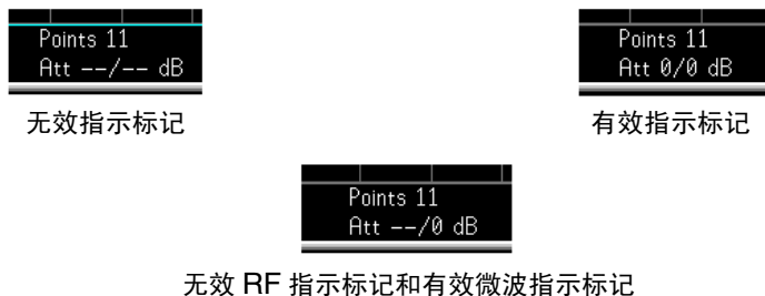
图 2-9 N8974A 和 N8975A 衰减器指示标记
